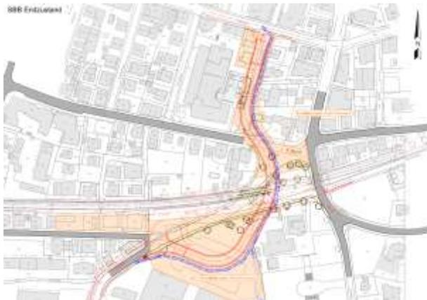
In roter Farbe sind die Installationsflächen für die Baustelle SBB und in oranger Farbe die Installationsflächen für die Strassenunterführung dargestellt.
