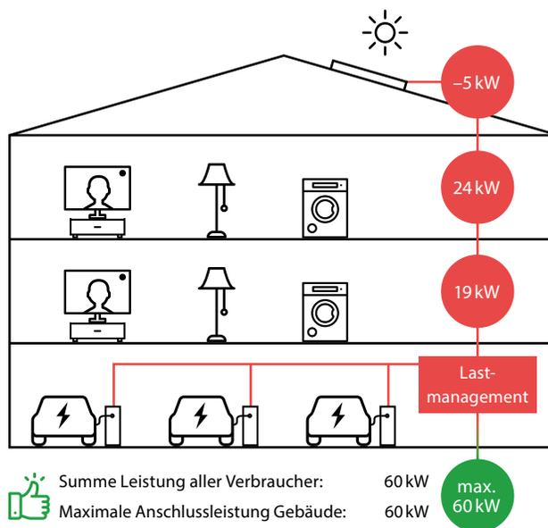
Unabhängig von der Anzahl Elektrofahrzeuge sorgt das Lastmanagement für genügend Strom bei allen Bezügern. Photovoltaikanlagen werden in das Lastmanagement ebenfalls eingebunden.
